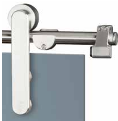
delta 1 glas zur Wandmontage Tragkraft 100 kg Laufschiennenrohr Länge: 2000 - 6000 mm Edelstahl matt
